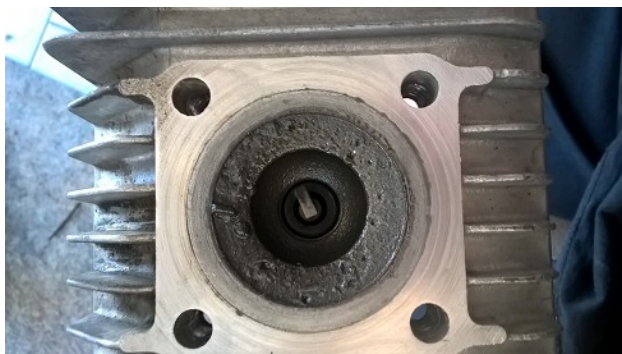
Obr. 6: Poškozená hlava válce se svíčkou. Barva izolátoru svíčky dokazuje chudší palivovou směs.
