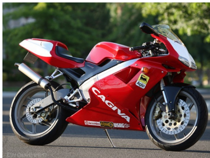
Obr. 2: Cagiva Mito 125 Evo – Stará Italská Cagiva nabízí sedmirychlostní převodovku, 22 kW a maximální rychlost 170 km/h při bazarové ceně okolo 30 000 Kč, navíc lze často řídit od 16 let a je tak vyhledávaným strojem mladých řidičů i přes pověstnou nespolehlivost.
