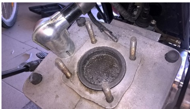
Obr. 7: Válec se zaseknutým pístem, který má z vrchu posekané dno.
