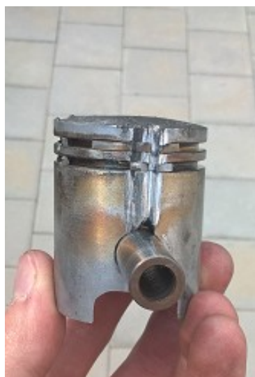
Obr. 9: Poškození pístu – rozdrčená strana pístu a pístních kroužků.
