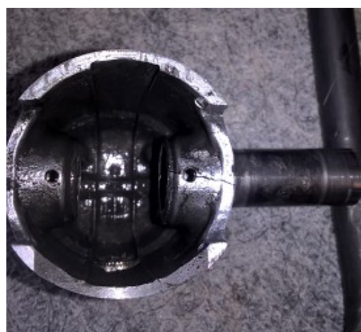
Obr. 10: Poškození pístu – prasklina v oku pístního čepu.
