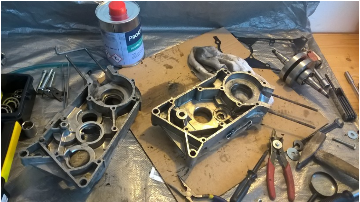
Obr. 15: Půlky motoru po rozlisování. Vpravo nahoře klikový hřídel, na kterém ještě zůstalo jedno z ložisek.
