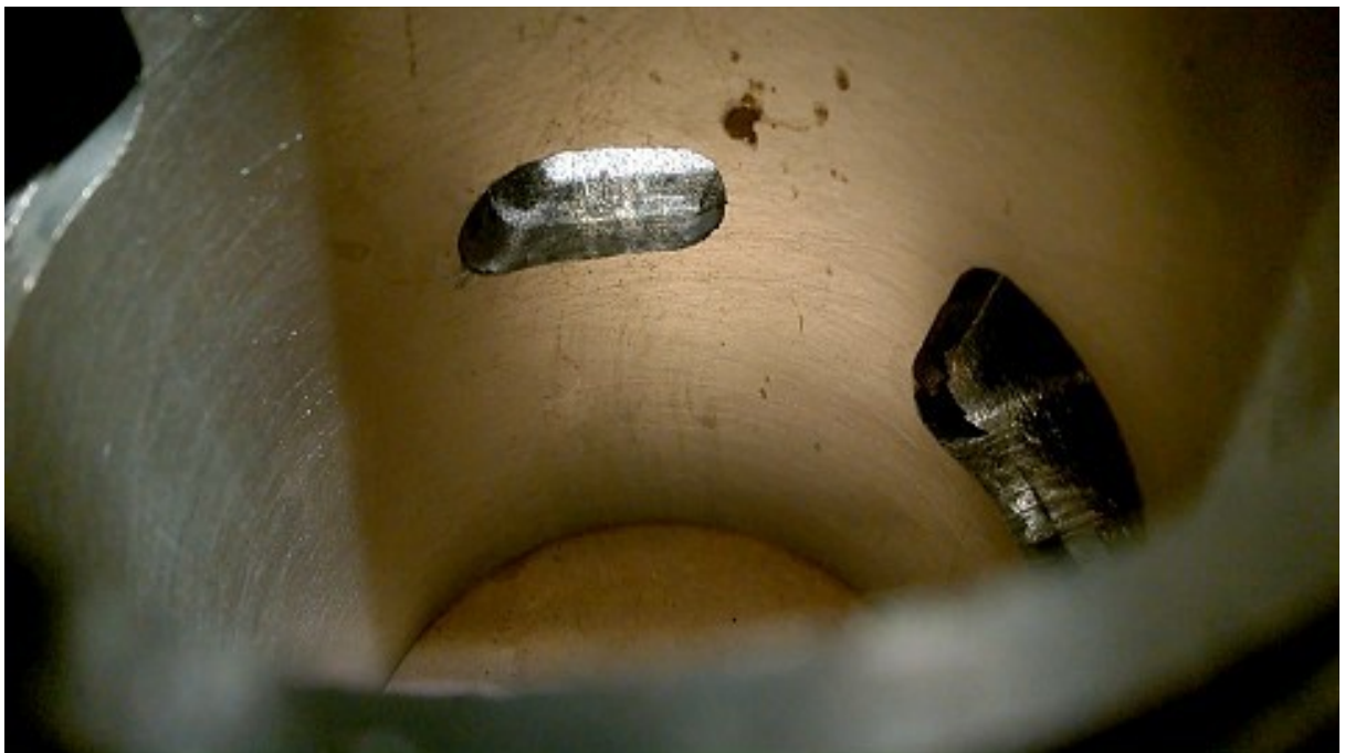
Obr. 25: Přepouštěcí kanál po slícování, v pravo výfukový kanál po zabroušení.
