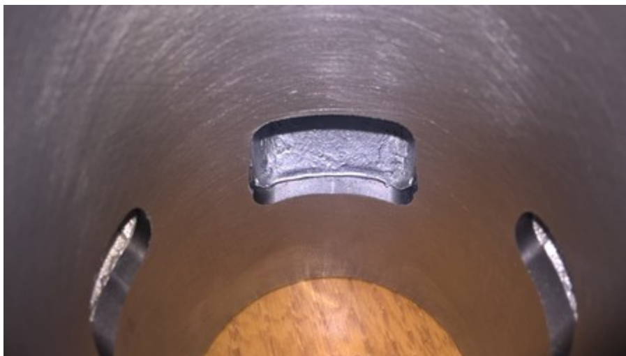
Obr. 22: Nálitek na výfukovém kanále. Lze si všimnout nalevo a napravo dole přepouštěcích kanálů, při detailnějším prohlédnutí lze vidět že hliníkový válec je „níž“ než hrana vložky a vzniká zde tak schod.
