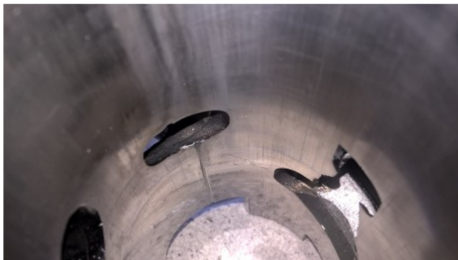
Obr. 8: Poškození válce. Uprostřed přepouštěcí kanál a dlouhá rýha až ke spodnímu okraji válce, napravo sací kanál s třetím přepouštěcím kanálem – mezi nimi byla původně vložka, kterou jehlička z ložiska vylomila.
