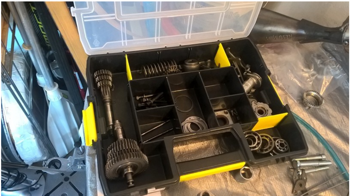
Obr. 16: Pečlivě uložené díly motoru. Vlevo dole převodovka, vpravo dole stará ložiska – je vhodné si je schovat, ještě nám pomohou při montáži jako distanční kroužky pro dotažení klikového hřídele.
