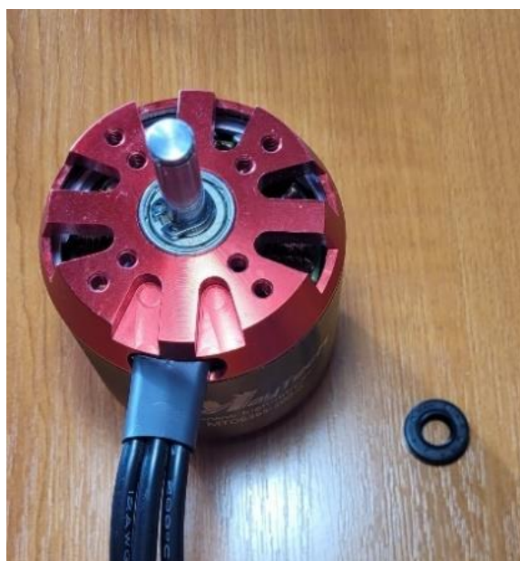
Obrázek 9: Ukázka čelní strany motoru a tlakového gufera, Zdroj: vlastní
