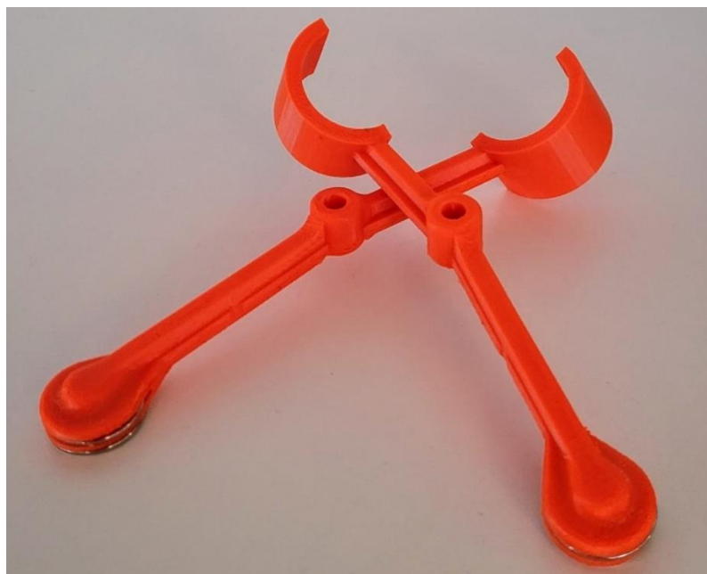
Obrázek 33: Ukázka táhel s neodymovými magnety, Zdroj: vlastní
