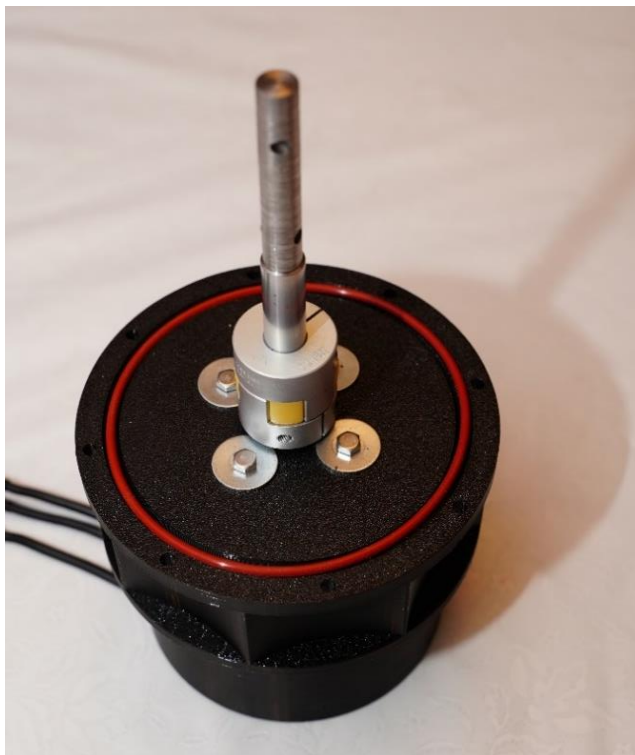
Obrázek 35: Nasazení spojky a vložení o-kroužku, Zdroj: vlastní
