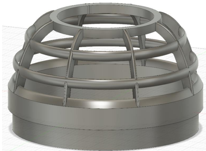
Obrázek 19: Model horní části ochranného koše, Zdroj: vlastní
