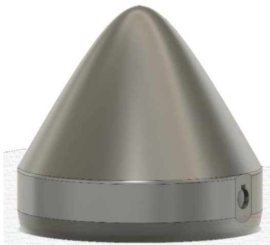
Obrázek 17: Model aerodynamické přední části, Zdroj: vlastní
