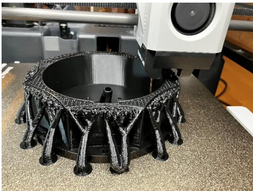
Obrázek 27: Tisk motorové části, Zdroj: vlastní
