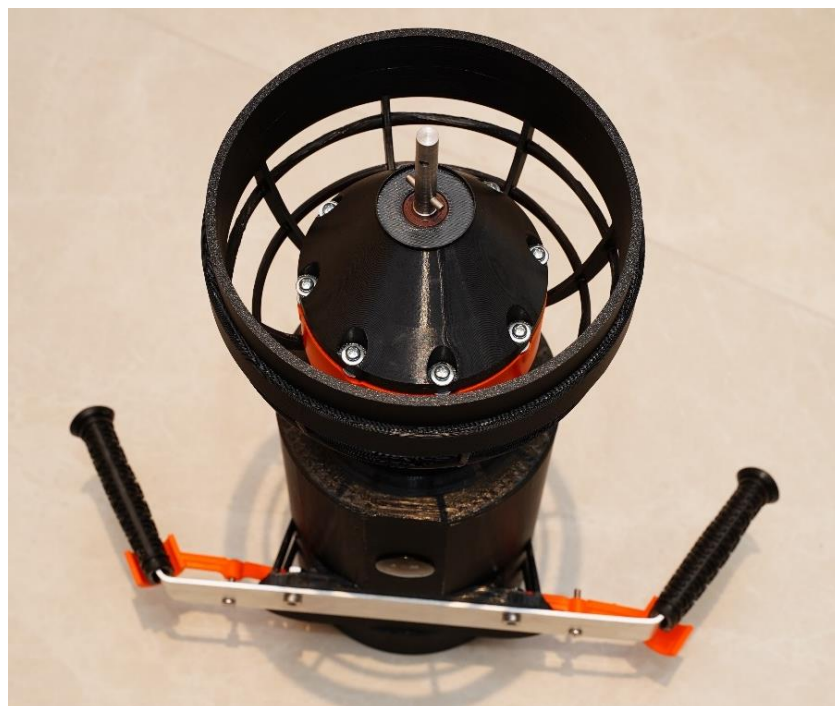
Obrázek 36: Kompletace skútru – před nasazením lodního šroubu, Zdroj: vlastní
