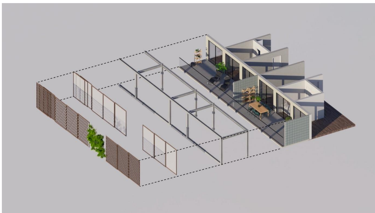
Obr. č. 26 – Schématická skladba lodžie
